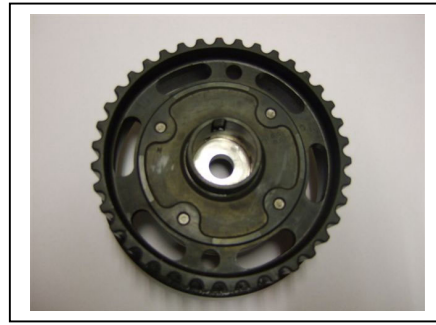
Ansicht Phasenversteller hinten
