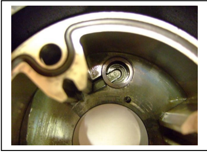
Lage und Kanäle der Verriegelung im Gehäuse
