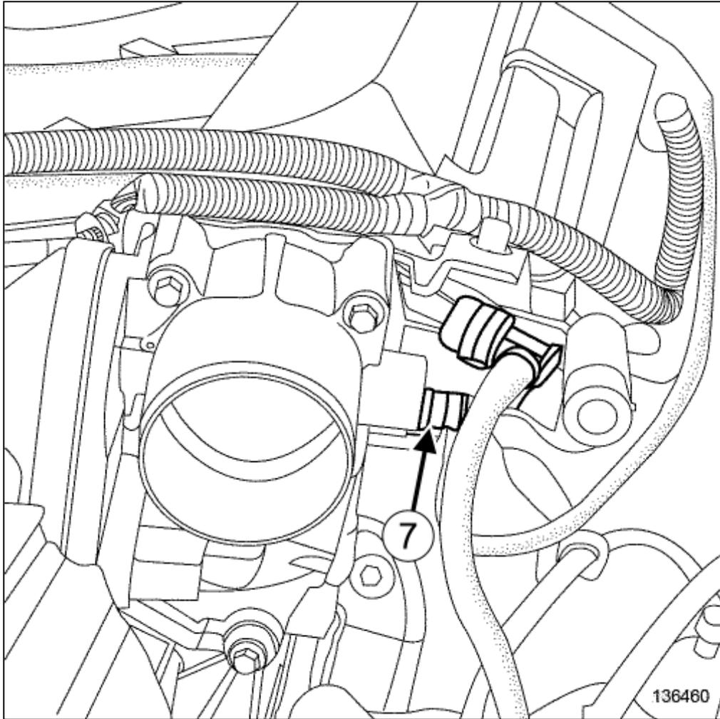
■ Den Anschluss(7) der Leitung des Kraftstoffdampf-Adsorptionsventils der Drosselklappeneinheit trennen.
